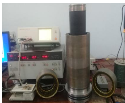
Hình 2. Hình ảnh khối phát sau khi bóc khỏi vỏ cao su bảo vệ
