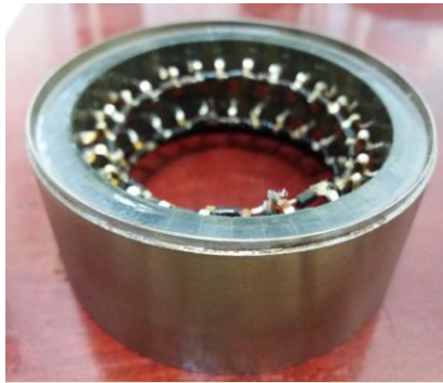
Hình 3. Một vòng của biến từ phát (trái) và cách ghép các thanh áp điện (phải)
