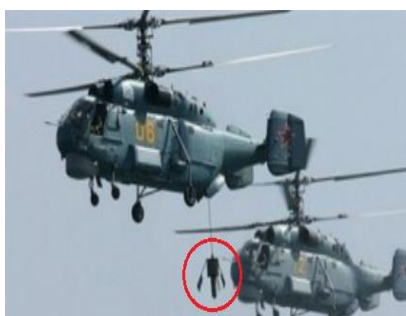
Hình 1. Khối phát - thu (trong vòng tròn) trên máy bay săn ngầm [1]
