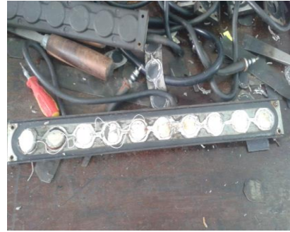
Hình 8. Một dãy 10 hộp cộng hưởng được nối dây sau phân cực (trái) và gắn vào thanh kim loại Ti
