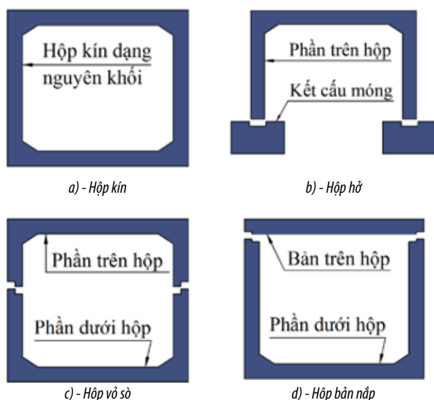
Hình 1. Các dạng kết cấu hộp lắp ghép
