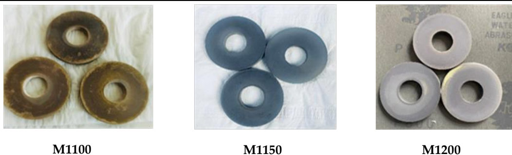
Hình 3. Hình ảnh các mẫu biến tử sau khi thiêu kết theo nhiệt độ M1100, M1150, M1200.
