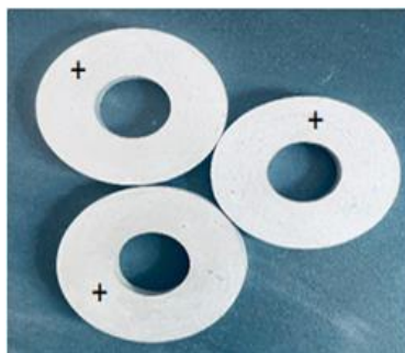
Hình 11. Hình ảnh của biến tử sau khi phủ cực.
