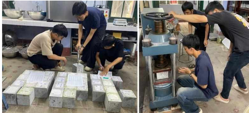
Hình 5. Ảnh chụp thí nghiệm xác định trị số bật nảy (bên trái) và cường độ chịu nén phá hủy (bên phải) của các mẫu bê tông xỉ thép BC540
